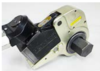
六角穴付きボルト締め用。ヘキサゴンアダプター。
