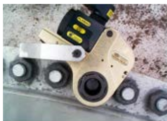
油圧トルクレンチの特殊反力受けの装着例
