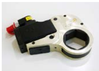
締付時の状態。緩め作業は裏表を反対にするだけで可能。
