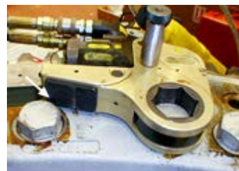
隣のボルト又は壁で反力を受けます。本体底部＝反力受け
