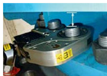
高さ制限のある狭いボルト締めで薄い油圧レンチVS型が活躍。
