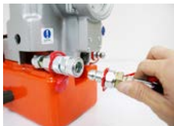
油圧ホースと油圧ポンプに接続して使用します。
