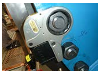
隣のボルトで反力を受けます。本体底部＝反力受け
