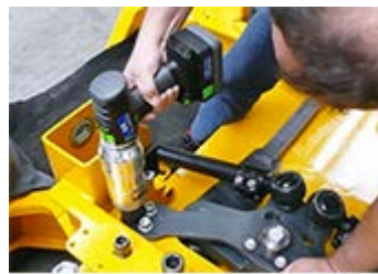
建機の組立、ボルト締めメンテ
