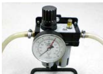
付属の精密エアレギュレーターでトルク設定を行います。
