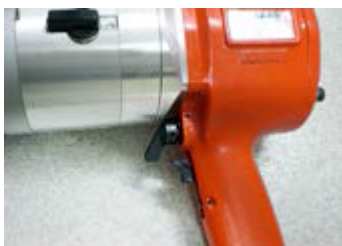
エアートルクレンチのトリガーを 引きながらレギュレーター調整
