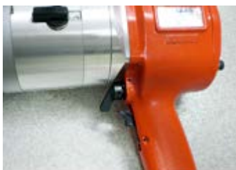
エアトルクレンチのトリガーを引きながらレギュレーター調整
