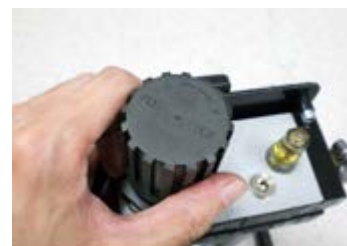
出力トルクのエア圧を調整。本体トリガーを引きながら設定。
