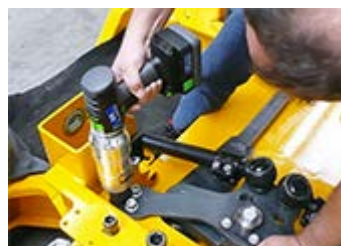
建機の組立、ボルト締めメンテ
