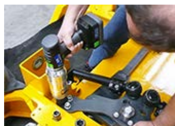
建機の組立、ボルト締めメンテ
