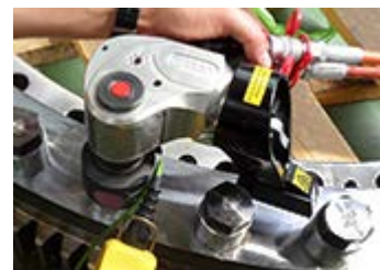
隣のボルトで反力を受けます。
