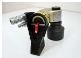
出力軸と平行になるように反力受けの向きを変えます。
