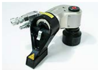
油圧トルクレンチの締め付け向き。緩め時は反対向きになります。
